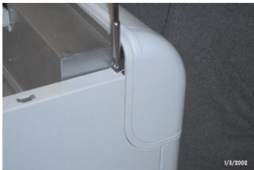
Afb. 5 - Draai de twee schroeven los en verwijder de twee plaatjes die het bedieningspaneel vasthouden.
