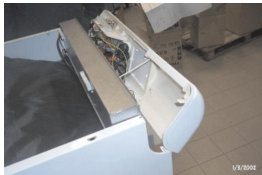
Afb. 6 - Laat het bedieningspaneel naar voren draaien.
